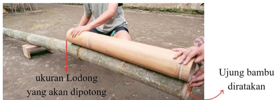
Gambar 1. Mengukur Bambu dengan Membandingkan Lodong Gejlig Sebelumnya
